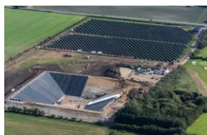
Fototermický systém pro dálkové vytápění – kolektory a zásobník tepla
